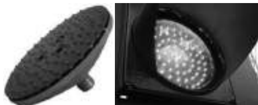
Figura 6.28 - la tecnologia dei semafori a LED
