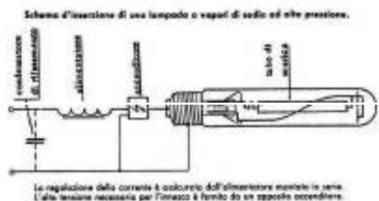
Figura 6.7 - lampada a vapori di sodio ad alta pressione (SAP)
